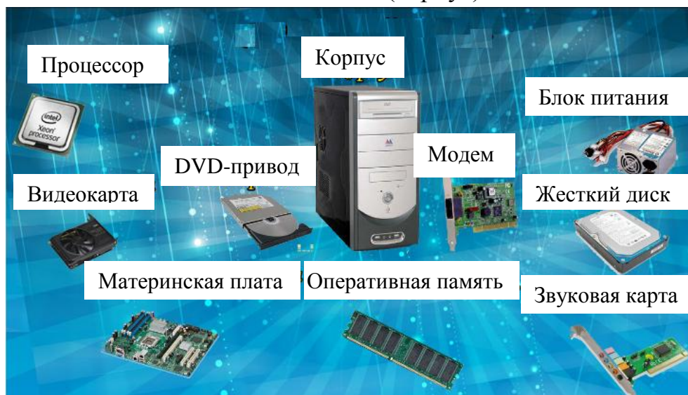
Рис.1.3. Системный блок компьютера и его основные компоненты
