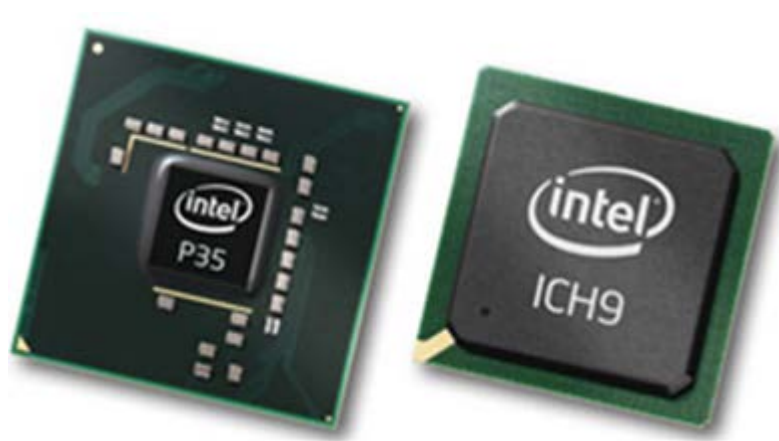
Рис 1.14. «Северный мост» и «южный мост» чипсета
